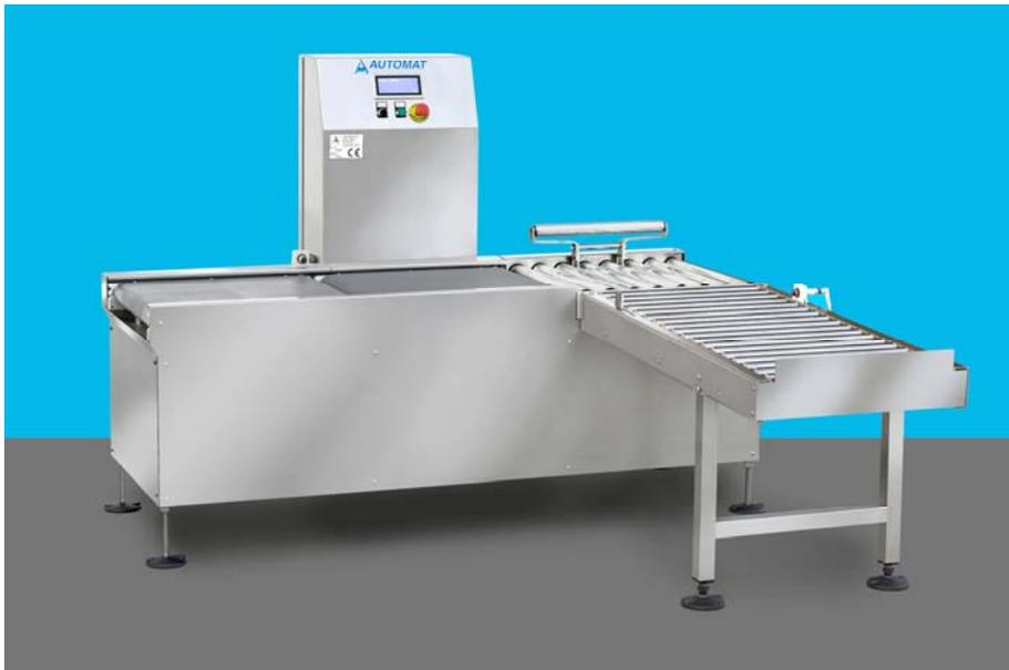
inconvenients en les écartant de la chaîne de production; la balance peut être utilisée dans les secteurs qui nécessitent un contrôle du poids à grande vitesse et de précision.
